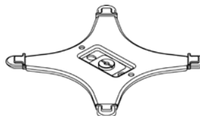
Подпора за квадратната плоча на везната (модели със скално деление d = 0,01 \text{ g}/0,1 \text{ g} )
