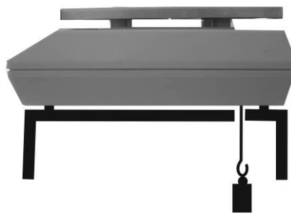
Фиг. 1: Подготовка на везната за претегляне отдолу
