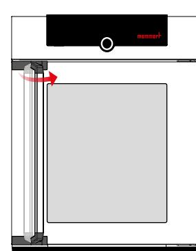
Aby zamknąć urządzenie, zamknąć drzwi i pociągnąć uchwyty w drugą stronę.
