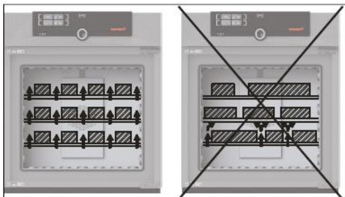
Фиг. 11 Правилно поставяне на пробите в работната камера
